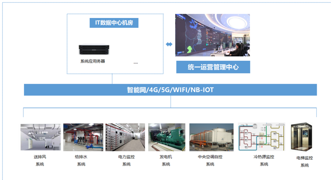
【智能建筑设施设备系统组成图】
